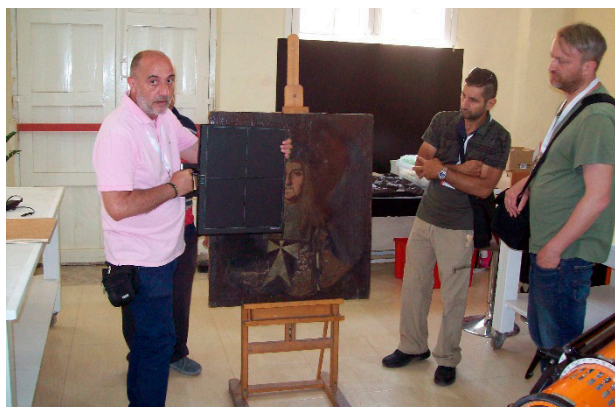
Fot. 2. Ekran fosforowy demonstruje David Baratto ekspert MAEA z firmy Gillardoni. Jak widać, obejmuje on około 25% płótna (fot. by W. Głuszewski)
