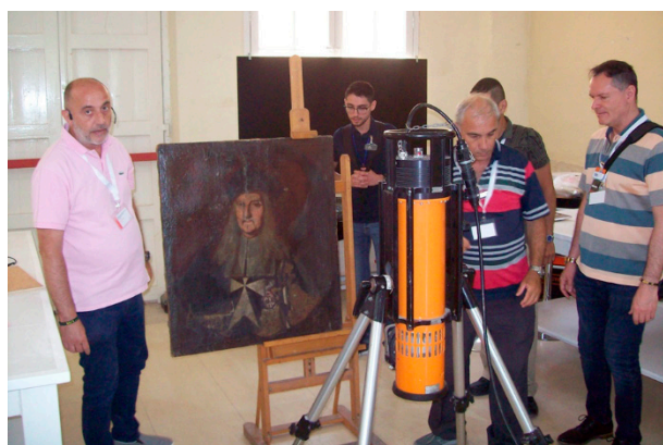
Fot. 1. Źródło promieniowania jonizującego umieszczone przed obrazem z kolekcji Muzeum Narodowego Malty. W celu wykonania oceny całego płótna należało wykonać kilku pomiarów kolejnych jego fragmentów (fot. W. Głuszewski)
