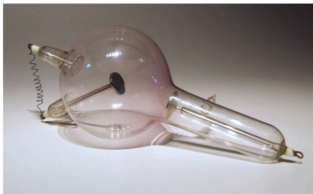
Fot. 1. Jonowa lampka do wytwarzania promieni X (ok. 1910 r.) [9] Photo 1. Ion tube for producing X rays (around 1910) [9]
