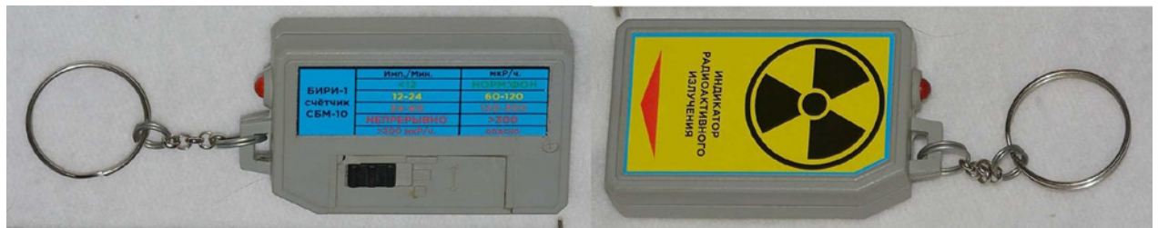
Fot. 2. Indykator promieniowania BIRI-1 z licznikiem SBM-10. Zwraca uwagę niska jakość tworzywa sztucznego i niestaranne wykończenie Photo 2. Radiation indicator BIRI-1, using SBM-10 miniature Geiger counter. Draws attention low quality of plastic and sloppy finishing
