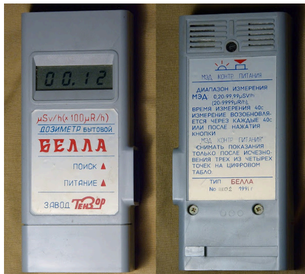
Fot. 7. Dozymetr „Biełła” – egzemplarz z fabryki „Tienzor”
