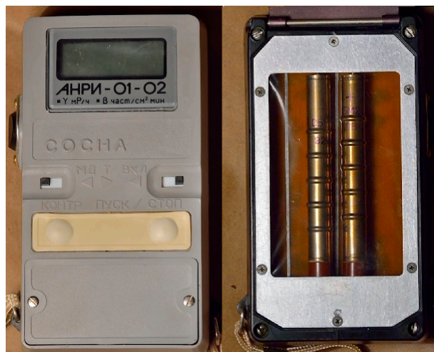
Fot. 13. Dozymetr-radiometr ANRI 01-02 Sosna w wersji z dwoma licznikami G-M umieszczonymi blisko siebie
