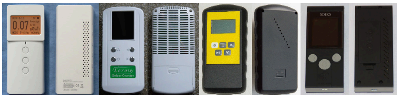
Fot. 1. Dozymetry z odsłoniętym detektorem - od lewej: KB-4011, LR-4011, FS-2011, Soeks 01M
