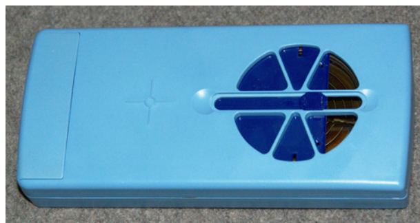
Fot. 5. Dozymetr Radex RD1008 — z lewej zaznaczony środek licznika promieniowania gamma typu Beta-2M, z prawej licznik promieniowania alfa i beta typu Beta-2 z częściowo uchyloną osłoną Photo 5. Radex RD1008 dosimeter — Beta-2M type gamma radiation counter marked on the left, Beta-2 type alpha and beta radiation counter with a partially opened cover on the right
