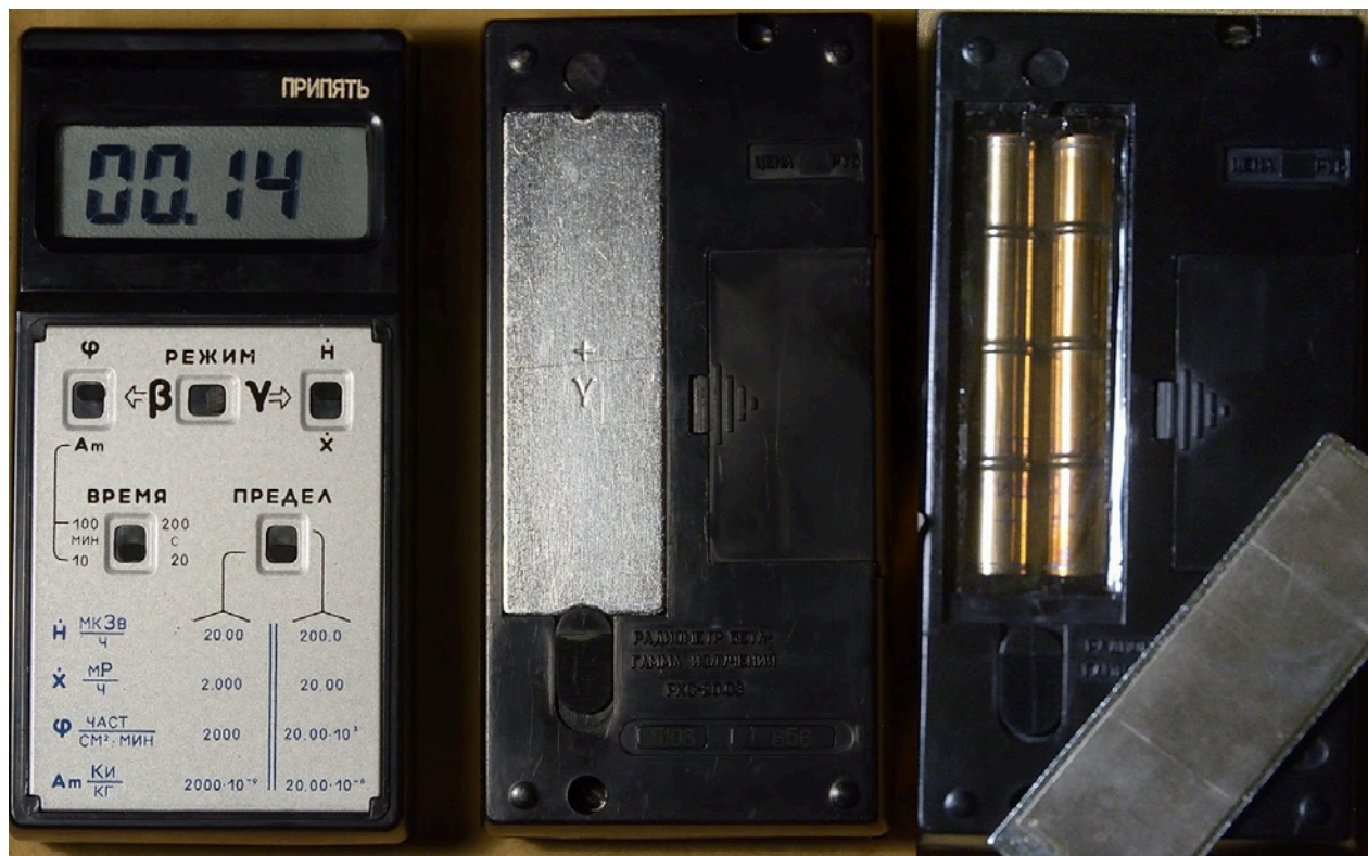
Fot. 3. Dozymetr RKS-20.03 Pripyat'. Widoczna klapka-filtr, osłaniająca detektory — dwa liczniki G-M typu SBM-20 Photo 3. Dosimeter RKS-20.03 Pripyat' \u0027. A visible flap-filter that covers the detectors — two G-M counters type SBM-20
