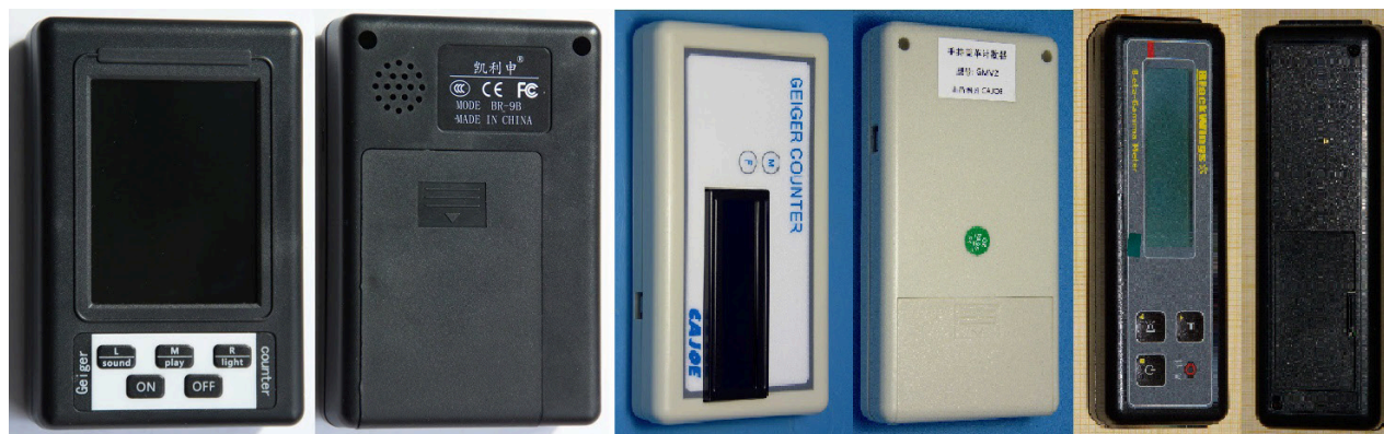
Fot. 2. Dozymetry w układzie z zakrytym detektorem — od lewej: BR-9B, Cajo JMV-2, BlackWings Photo 2. Dosimeters with a covered detector — from the left: BR-9B, Cajo JMV-2, BlackWings
