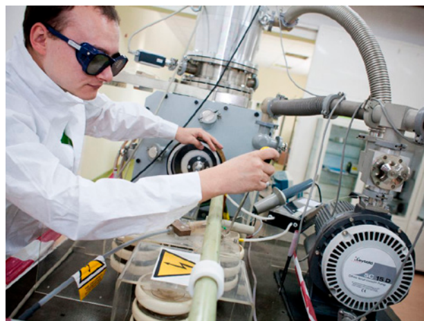
Fot. 7. Stanowisko do badania emisji jonów z tarczy naświetlanej laserem w IFPiLM (fot. IFPiLM)
